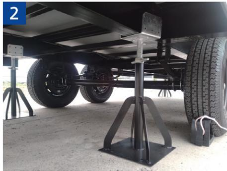
2 車輪以外のもので地盤上に支持されている場合、その支持構造体が工具無しで取り外しができること。
